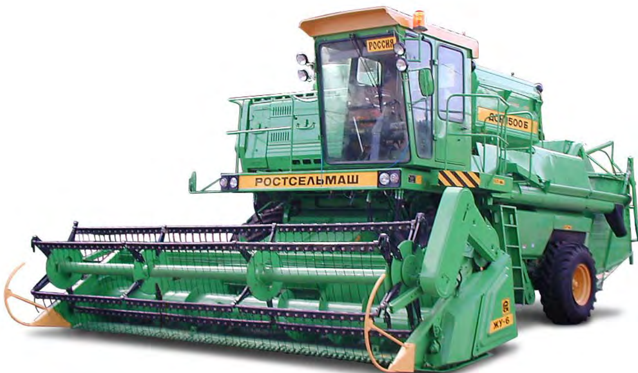
Общий вид комбайна зерноуборочного самоходного с жаткой и копнителем General view of the self-propelled grain harvester with reaper and stacker
