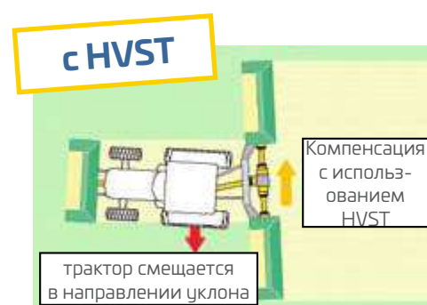
Компенсация дефектного среза с использованием HVST: Результатом является равномерная поверхность жатвы
