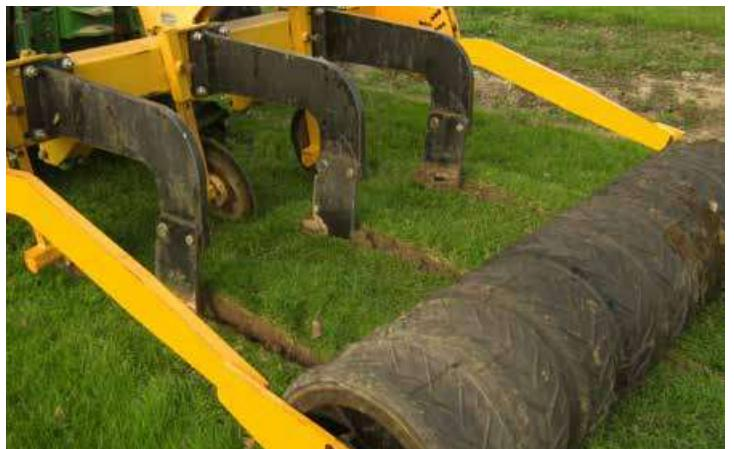
Модель для пастбищ и сенокосных угодий с катком Flexi-Sem Ø540 мм
