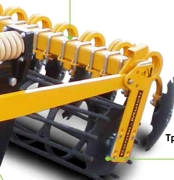
Система регулировки рабочей глубины Multistop
